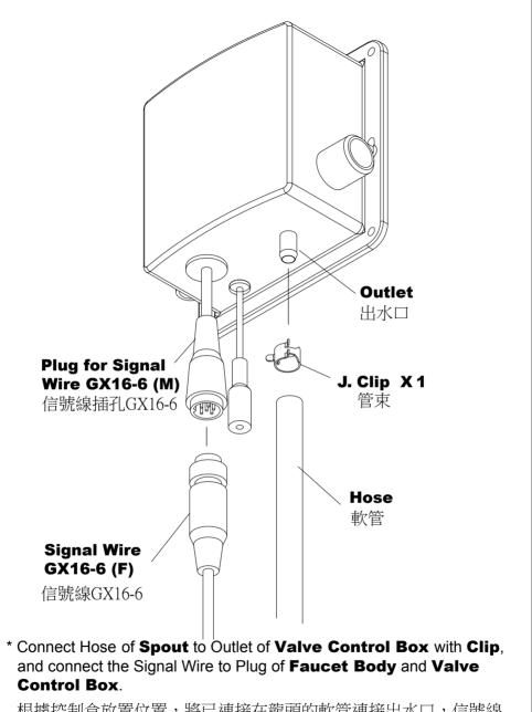
根據控制盒放置位置,將已連接在龍頭的軟管連接出水口,信號線 連接至信號線插孔。
